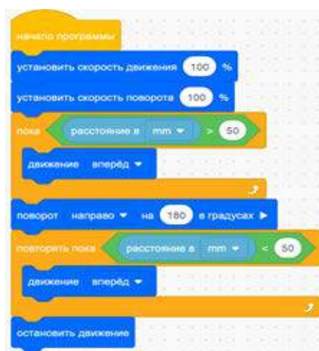
Рис. 26. Отличия циклов в VEX VR
